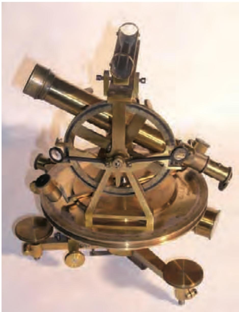
Teodolite, strumento ottico a cannocchiale per la misurazione degli angoli azimutali e zenitali, usato per rilievi geodetici e topografici. La foto ritrae un ottimo esemplare “Pistor e Martins”, privo di livella
